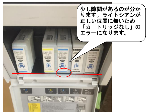
【奥に押し込んで戻らず正しい位置でない状態】
